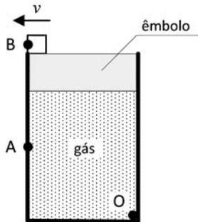
A figura acima mostra um recipiente com paredes transparentes de espessuras desprezíveis. Esse recipiente contém um gás ideal hipotético e é fechado por um êmbolo opaco. Inicialmente, um corpo encontra-se apoiado sobre o êmbolo, em sua extremidade, mantendo todo o sistema em equilíbrio. Uma microcâmera, posicionada no ponto O (interior do recipiente) e direcionada para o ponto A, consegue filmar o ponto B no corpo.
