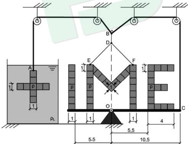
O sistema apresentado na figura encontra-se em equilíbrio estático, sendo composto por quatro corpos homogêneos, com seção reta na forma "+ I M E". O corpo "+" está totalmente imerso em um líquido e sustentado pela extremidade A de um fio flexível ABC, de peso desprezível, que passa sem atrito por
