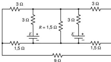
A figura acima apresenta um circuito elétrico composto por duas baterias iguais e oito resistores. Determine o valor das baterias para que a potência elétrica no resistor  $R$  seja igual a 6 W.
